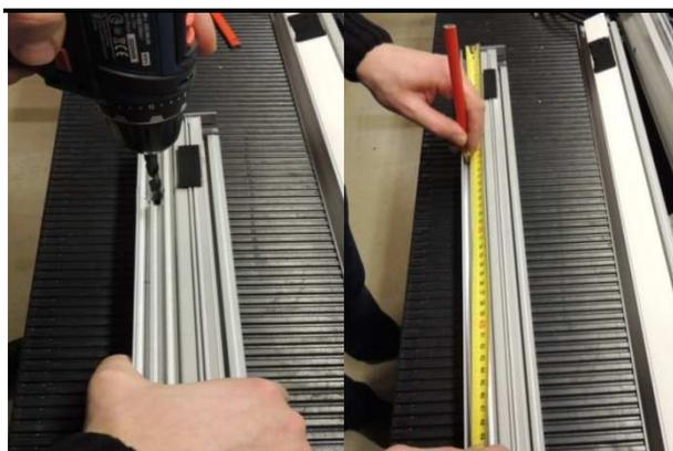
6. Bestimmen und Bohren Sie die Löcher in der Führungsschiene gemäß Zeichn. 9, falls keine vorhanden sind.
