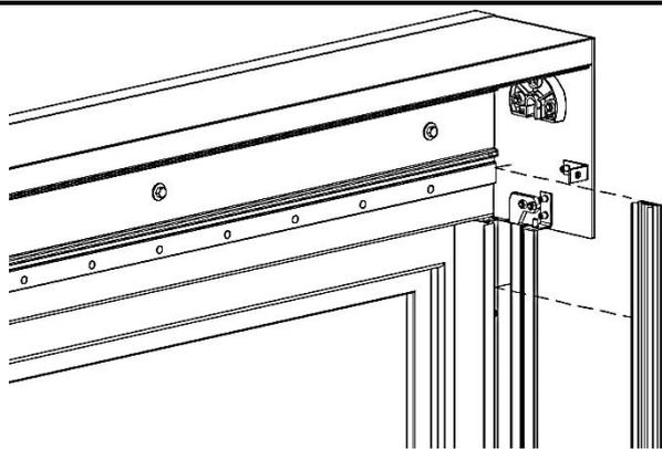
10. Stecken Sie nun das Führungsprofil in die Führungsschiene.
