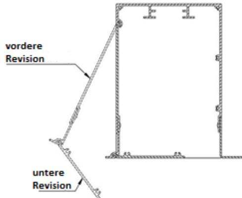
14. Montieren Sie den vorderen und unteren Revisionsteil der Kassette gemäß Zeichn. 18, 19 und 20.
