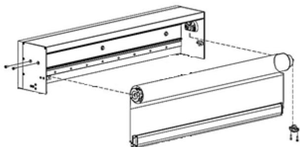
1. Demontieren Sie das Wickelrohr mit Behang und Fallprofil.
