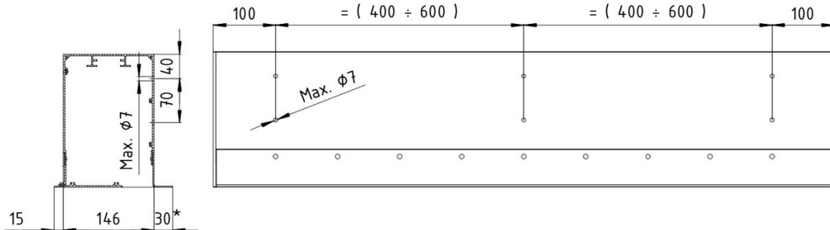
Zeichn.8. Schema zur Ausführung der Bohrlöcher in der Unterputzkassette \* - standardmäßig 30 mm bei Box 2.
