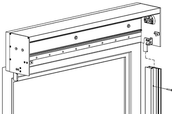
7. Stecken sie die Führungsschienen auf die Zapfen der Kassette und befestigen diese am Untergrund oder der Unterkonstruktion.
