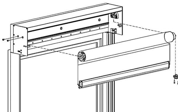
8. Montieren Sie das Wickelrohr mit Behang und Fallprofil wieder in der Kassette.
