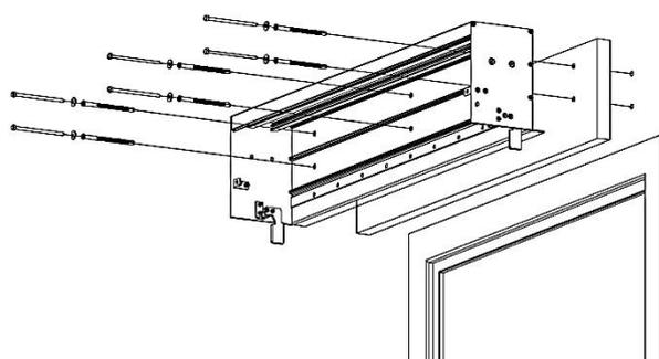
4. Bohren Sie die Löcher in die Kassette gemäß Zeichn. 8.
