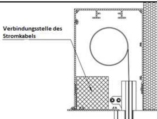
13. Schließen Sie das Montagekabel an und prüfen, ob das System ordnungsgemäß funktioniert und die Endlagen richtig eingestellt sind. Führen Sie falls nötig Änderungen durch.
